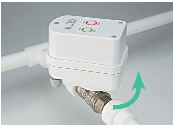
Фото 27. Удаление металлического фиксатора для отсоединения электропривода от шарового крана или ручного управления шаровым краном
